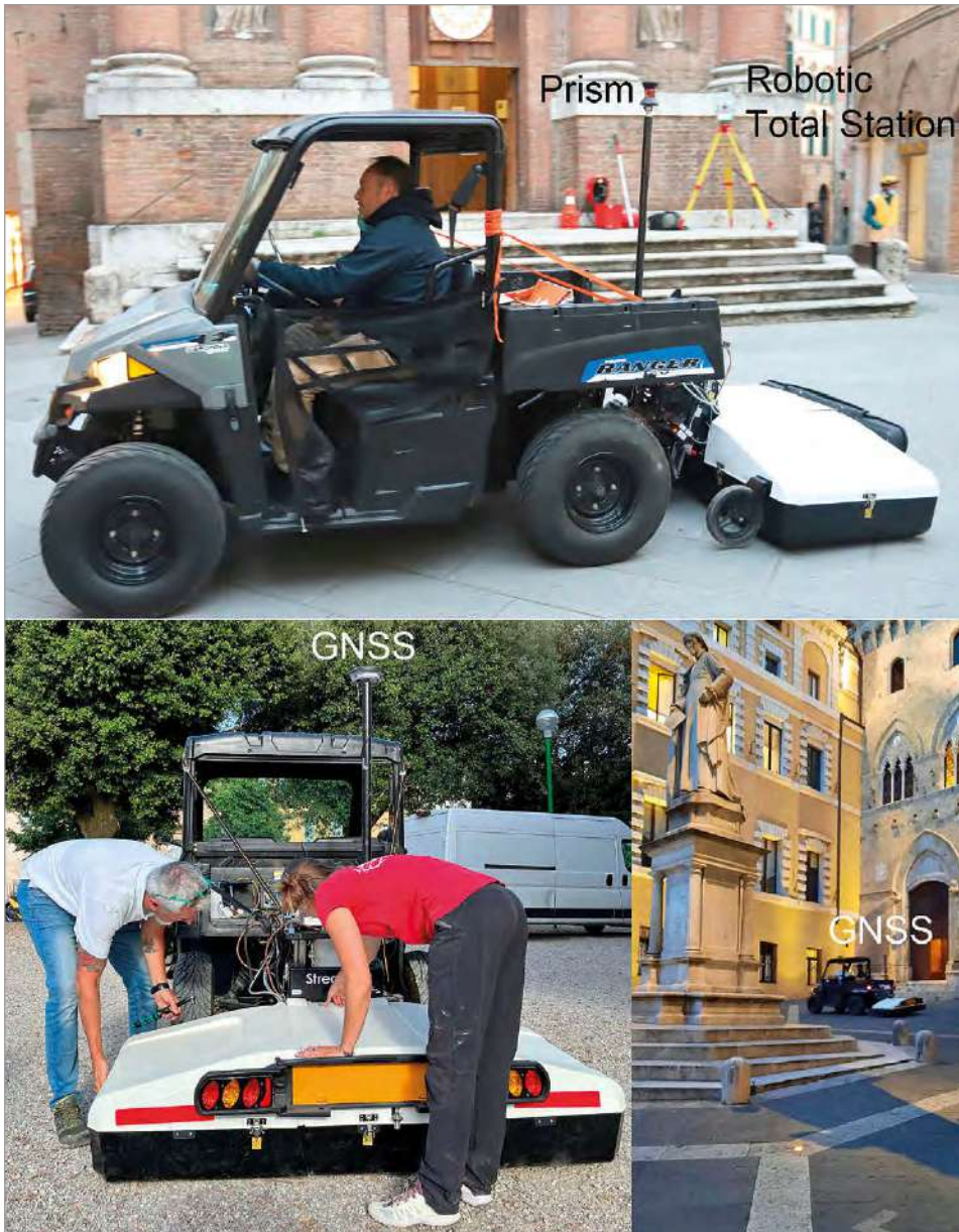
fig. 3 – Sistema di acquisizione dati GPR IDS Stream UP (200 MHz polarizzazione VV/600 HH) trainato da un veicolo elettrico. In alto la georeferenziazione delle misure è eseguita con la stazione totale robotica mentre in basso con il sistema di georeferenziazione satellitare e la piattaforma IMU.
