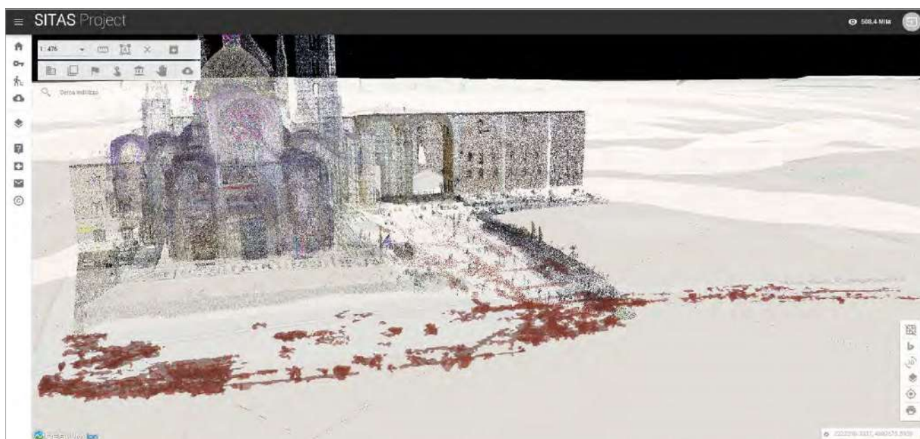
fig. 7 – La visualizzazione degli elementi 3D (point clouds e mesh poligonali) nel sistema SITAS.
