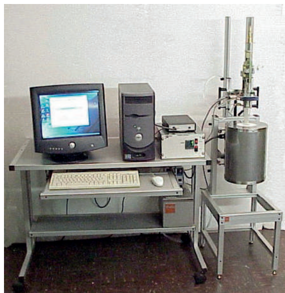
Figura 11 – Dilatometro a geometria verticale per misure di viscosità per temperature < T_g , il tutto gestito da software dedicati (Vetere et al. 2006, 2008).
