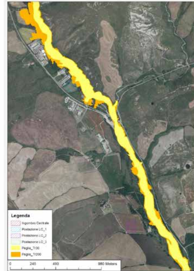
Figura 4.8 – Mappa aree interessate dalle piene del solo fiume Paglia con tempi di ritorno di 30 e 200 anni
