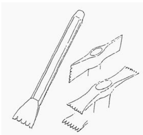
Fig. 10- Gradina e martellina dentata da BIANCHI-PARENTI 1991
