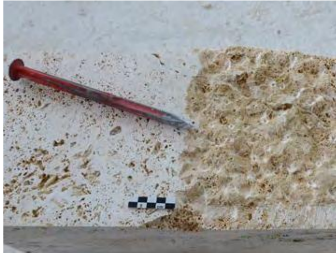
Fig. 6 - Tracce superficiali della subbia
