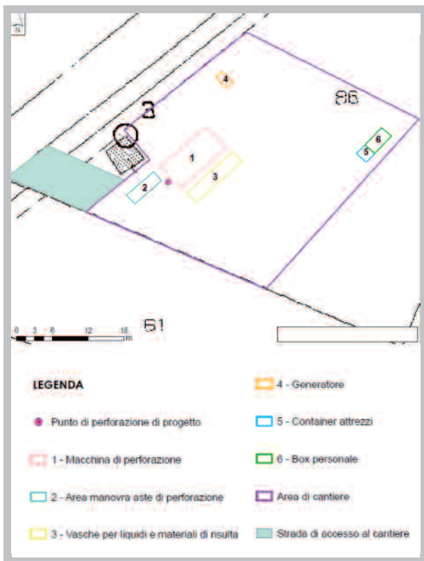
▲ Figura 4: Organizzazione dell'area di cantiere
