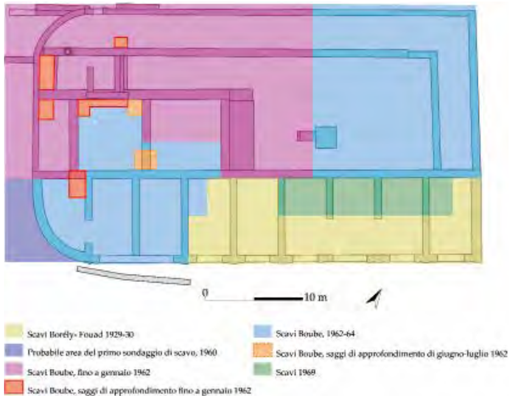
Fig. 1.4. Pianta schematica del Capitolium con i limiti degli scavi eseguiti fra il 1961 e il 1969, desunti sulla base della documentazione d'archivio.
