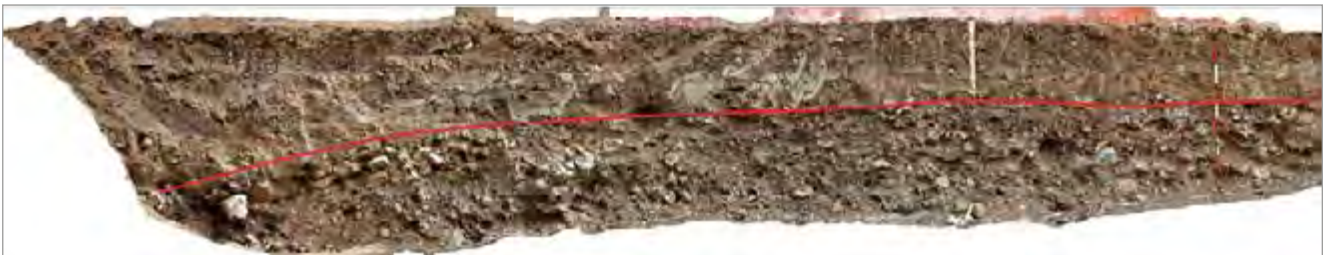
fig. 160 – Ficarella. Sezione dove è visibile in basso, delimitata dalla linea rossa, la conoide composta da terra, roccia e ghiaie.
