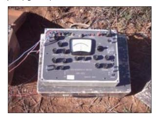
Figura 25: strumentazione utilizzata per l'esecuzione dei S.E.V.
