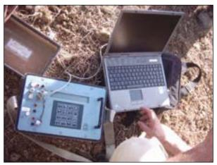
Figura 27: Syscal R1 connesso al Pc in fase di configurazione dell'array
