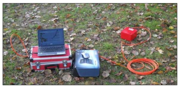
Figura 33: Attrezzatura tecnica per la realizzazione di indagini HVSR
