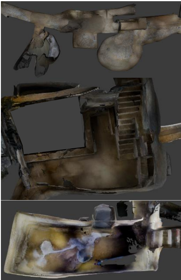
Figures 4 a-b-c: LiDAR surveyed sectors in the bottino maestro of Fonte Gaia (a), in the Fonte delle Monache (b) and in the Fonte di Pescaia (c)
