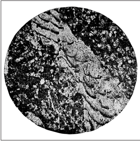
Fig. 1 – Microfotografia in sezione sottile di un campione di calcare bianco ( palombino ) proveniente da Ostia Antica (da DE ANGELIS D'OSSAT 1934, cit. a nota 21).
