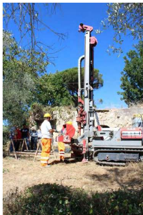
Fig. 1.1.18 - Guado San Nicola. Sondaggio stratigrafico a carota continua che ha raggiunto la profondità di 20 metri (foto C. Peretto).
