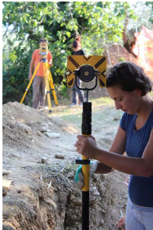
Fig. 1.1.14 - Guado San Nicola. Utilizzo della stazione totale per la georeferenziazione dei reperti rinvenuti (foto C. Peretto).
