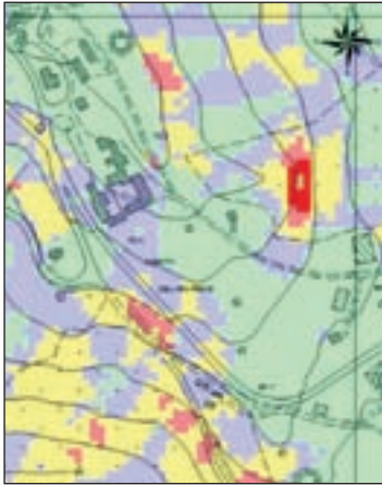
▲ Figura 8: Particolare della carta degli indici di stabilità in località “Casetta dell’Arciprete” con i parametri originali.
