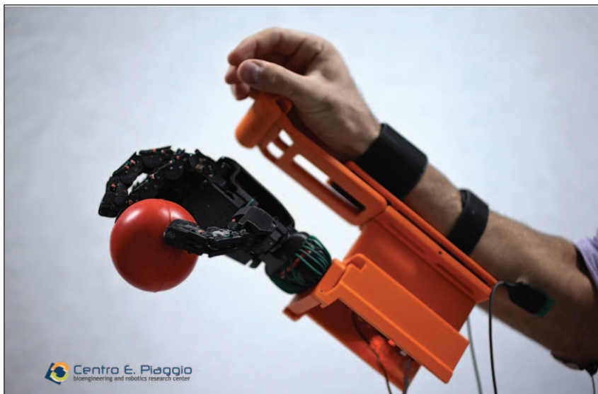
Figura 13. Mano di un robot che replica le capacità di afferraggio dell'uomo (Cortesia, A. Abrusci)
