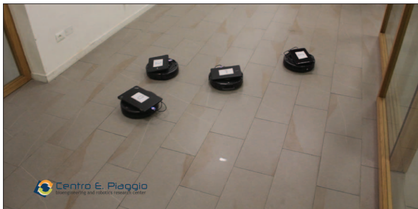
Figura 17. Test sull'algorithmo di controllo di una flotta di AGV
