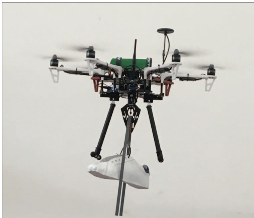
Figura 18. Test di afferraggio, sollevamento e movimentazione di un oggetto di forma non regolare da parte di un drone
