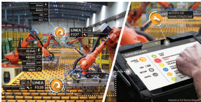
Figura 14. Manutenzione basata sui dati pervenuti dai sensori sulla linea
